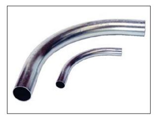
Las Curvas se utilizan para conectar tubos EMT y cambiar la dirección de la instalación. Son Fabricadas del tubo EMT de acuerdo con las últimas especificaciones y normas de ANSI C80.3 (UL 797). Las superficies interior y exterior de las curvas están libres de defecto con una costura soldada suave, y también están recubiertos uniformemente con zinc mediante el proceso de galvanizado en caliente, ello le proporciona una protección galvánica contra la corrosión.
