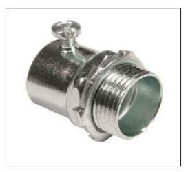
Los Conectores EMT son utilizados para fijar tubos conduit EMT en las entradas de las cajas de pase. Son Fabricados en acero, están certificadas según norma UL 514B, CSA C22.2 18.3
